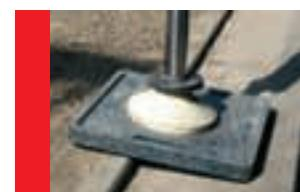
Stützbretter müssen völlig plan auf dem Boden aufliegen, damit die Stützen nicht abrutschen können.
