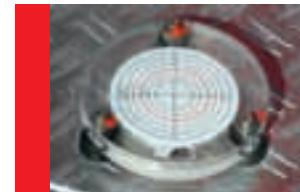
Stützen Sie die Bühne waagerecht ab und verwenden Sie immer Unterstellbretter.
