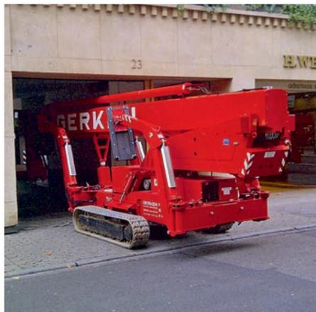
Mit abgesenktem Fahrwerk und in Kriechgeschwindigkeit manövriert der Spezialist von Gerken diese GSA 36 G durch die niedrige Einfahrt.
