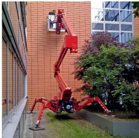
Das ganze Programm: Geländestufen, schräge oder unebene Untergründe oder aber Gebäudebauteile wie Podeste oder vorspringende Dachelemente stellen für die Gerken Spezialgeräte durch ihre spinnenartige Abstützung kein Problem dar.
