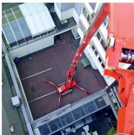
Im Innenhof angekommen, entfaltet sich die GSA 36 G und nimmt vollautomatisch die Einsatzposition ein. Alles Weitere ist Routine: Das Teleskop fährt auf die maximale Arbeitshöhe von 36 Metern aus und ermöglicht die Reinigung des Gebäudes.
