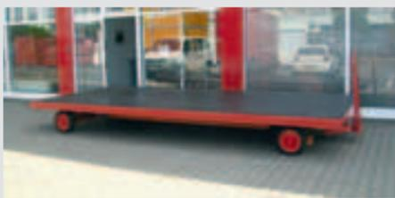
**MAH I10000** nimmt Lasten von bis 10 Tonnen auf und kann mit seiner 4-Rad-Lenkung und den Vollgummireifen ideal auf Baustellen oder in der Industrie eingesetzt werden, um die vielfältigsten Lasten zu transportieren.
